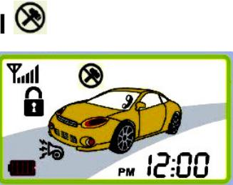
Vypnutie prídavných čidel sa využíva, ak si neželáte, aby počas stráženia auta alarm reagoval na otrasy a snímal interiér.
