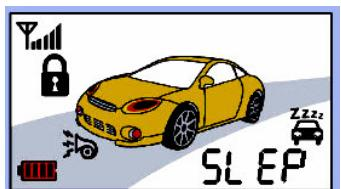
Do servisního režimu se můžete dostat i zapnutím/vypnutím zapalování 3x během 3 sekund, nebo pomocí 2 – místního PIN kódu viz.str.32
