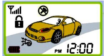
Odstavení senzorů je vhodné, necháváte-li v autě psa nebo dítě. Senzory jsou sice vypnuty, ale alarm auto nadále hlídá ( sledování kontaktů dveří, kufru a kapoty se nevypíná).
